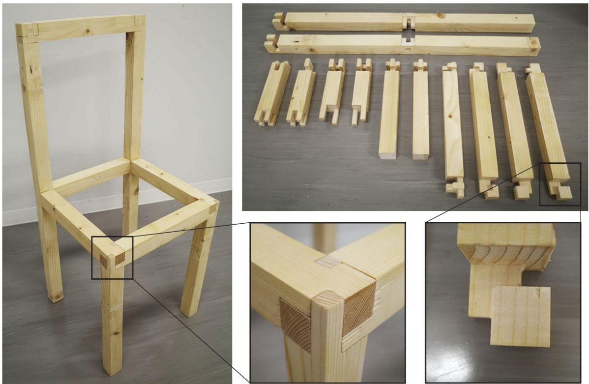
図4：開発したシステムを利用して設計・製作した椅子の例。釘や接着材を使わずに、組み立て、分解、再組立てが可能である。
